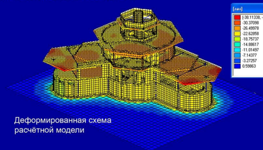
цветовое изображение изгибающих моментов в расчётных схемах перекрытий подвала и первого этажа
